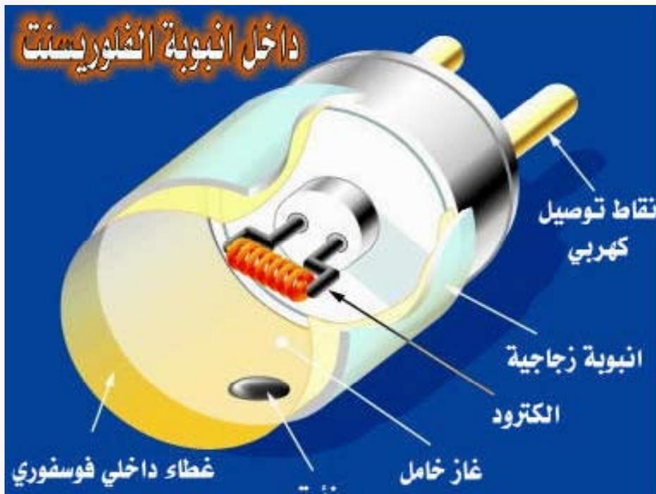
العنصر الأساسي في انبوبة النيون هي الانبوبة الزجاجية المفرغة من الهواء. هذه الانبوبة تحتوي على القليل من جزيئات الزئبق Hg وغاز حامل هو الأرجون Ar عند ضغط منخفض. كذلك تغطي سطح الانبوبة الداخلي طبقة من مادة فوسفورية. يوجد على طرفي الانبوبة إلكترود للتوصيل الكهربائي وفي داخل الأنبوبة يتصل الإلكترود بفتيلة حرارية تطلق الإلكترونات عندما تسخن بمرور التيار الكهربائي بها.
