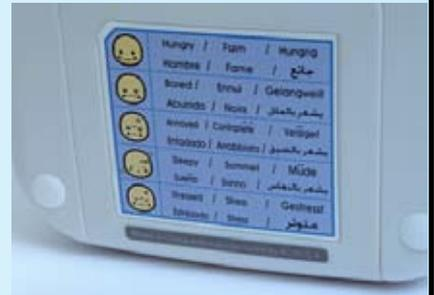
يعمل جهاز «Baby Crying Analyser» عند التقاط صوت البكاء بمجرد وضعه على مسافة مناسبة من الطفل عن طريق لاقط صوتي حساس ومن ثم يقوم الجهاز بعملية المعالجة الرقمية للصوت من خلال قياس شدة البكاء وقوته. تردده. تفاوت الصوت. فترات الصوت ومطابقة التحليل مع أنماط تم تحميلها مسبقاً. ليضئ مصباح صغير على شاشة الجهاز مشيراً إلى السبب المحتمل الأقوى لبكاء الطفل.
