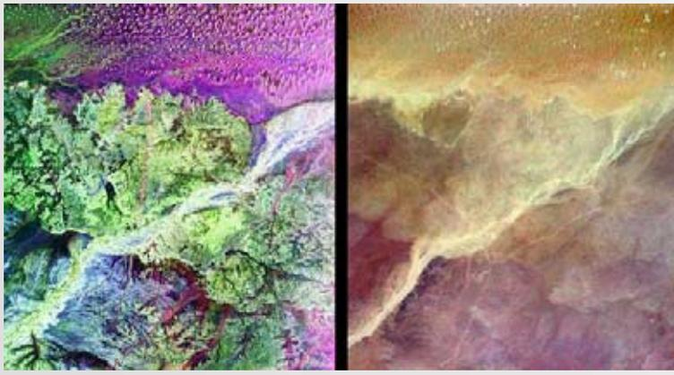
من هذه الصور الجوية الأولى تطورت وسيلة جديدة تسمح للعلماء بتحليل سطح الأرض وتمييز معالمه الجغرافية بشكل لا يمكن استيعابه عادة بالعين المجردة. وتقوم تقنية الاستشعار عن بعد على استخدام الأقمار الصناعية المجهزة بحساسات خاصة تسجل الأمواج الكهرومغناطيسية المختلفة التي تنبعث من سطح الأرض. ثم تغذى هذه المعلومات لاحقاً إلى شبكات قوية من الكمبيوترات لتعالجها وتسمح للعلماء بأن يروا من الفضاء ما هو غير مرئي لهم عادة على الأرض وتحديد المواقع الأثرية.
